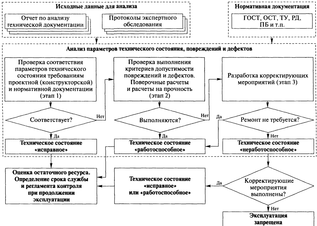
Рисунок 8.1 – Процедура оценки технического состояния сосуда
